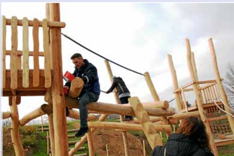
TÜV-Prüfer Brcic testet mit der Form in Größe des Kopfes eines Kindes auf Gefahrstellen
